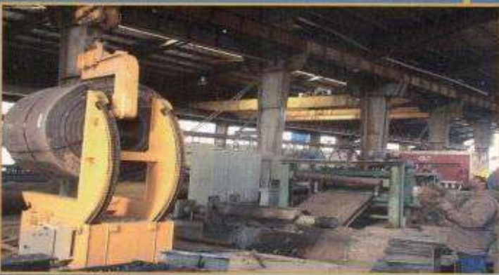
— باز کردن ورقهای رول نا ضخامت ۲۵ میلی متر
