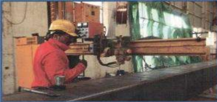
جوشکاری الکترو اسلک (جهت جوشکاری وجه چهارم ستونها)
