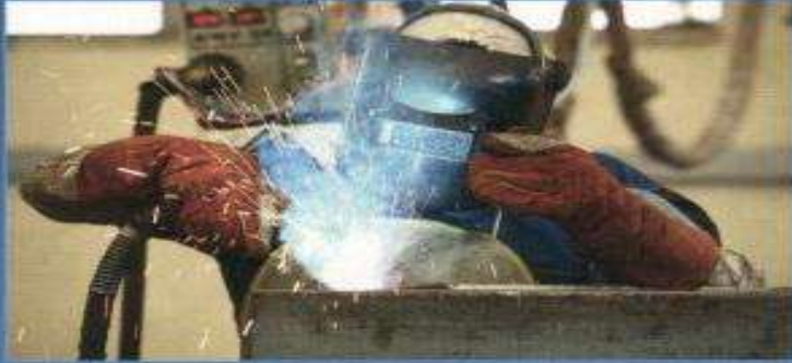
جوشکاری CO2 و میکس (جهت انجام جوشهای نفوذی و قطعات)
