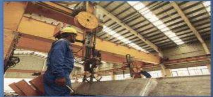
جوشکاری زیر پودری (جهت جوشکاری طولی تیر و ستون)
